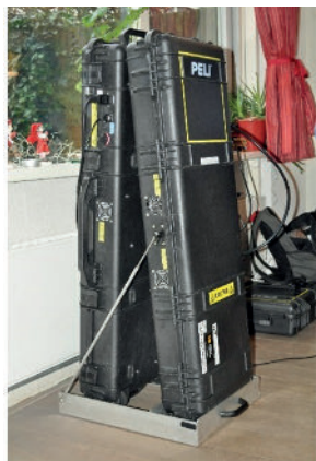
Fig. 1. Een veldengenerator. Naar keuze wordt of een radiofrequente unit (hier afgebeeld) of een ELF unit geïnstalleerd
