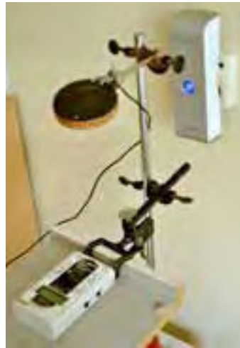
Voorbeeld van een test op magneetveldbeïnvloeding.. Een spoel (rond, zwart) wordt bekrachtigd door een 5 kHz wisselstroom en verspreid een veld waarvan de magnetische flux gemeten wordt met een ME3851A veldmeter. Gekeken wordt of na inpluggen van de Memon (rechtsboven) een verandering van het veld optreedt.
