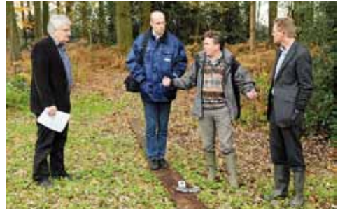
Uitleg van Marcel over de geringe magnetische veldsterkten van frequenties >2kHz naast de grondkabel in de achtertuin. Let op de meter op de grond die slechts 0,2 nanoTesla aanwijst.
