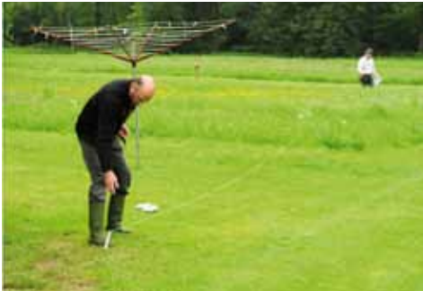
Fig. 6 Meetspecialisten in actie. Metingen van veldsterkte op en rond grondkabel volgens een gridpatroon van 20 x 20 m
