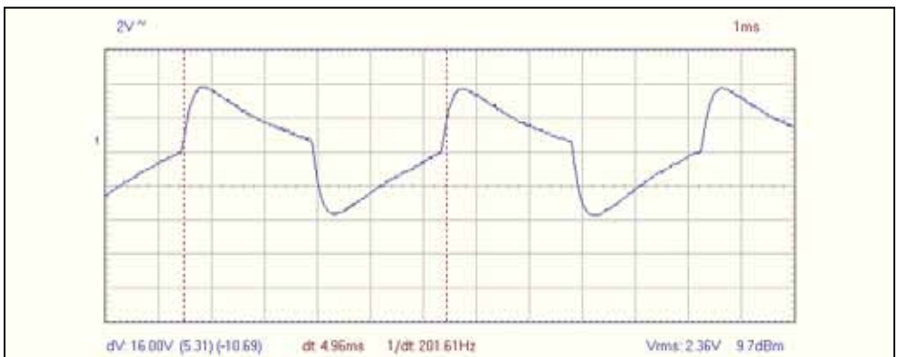
Profiel van het magnetische 201Hz wisselveld bij een helderheid van LCD scherm ingesteld op 50%. Karakter van golfvorm: afgeronde blokspanning.
