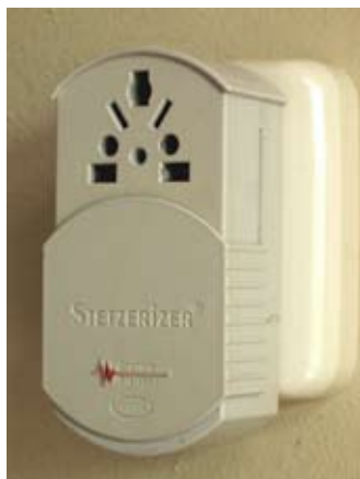
Figuur 3. Het Graham-Stetzerfilter, dat de hoge frequenties uit de netspanning opneemt. De meterwaarde zal dan teruglopen.
