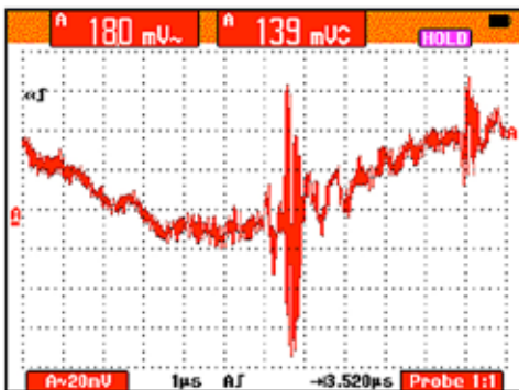
Fig. 3B. Dezelfde pulsen, nu op een 10x uitgerekte tijd-as waar-door het complexe karakter van de 'puls' zichtbaar wordt.
