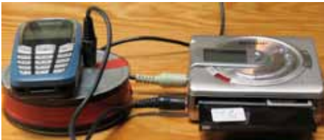
Fig. 1. Opstelling om pulsen af te leiden van een mobieltje. Een spoel vangt de magnetische wisselvelden uit het mobieltje op en stuurt de wisselspanningen naar bijvoorbeeld de voorversterker van een minidiskrecorder voor opslag en verdere bewerking, of naar een oscilloscoop voor analyse van puls vorm.
