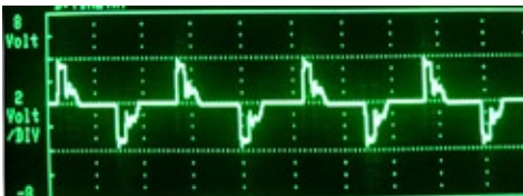
Fig.8. Spaarlamp. Profiel van 50Hz magnetisch wisselveld binnen draad. Het sinusprofiel is sterk verstoord door positieve en negatieve veldrimpelingen. Horizontaal de tijd, verticaal de veldsterkte.
