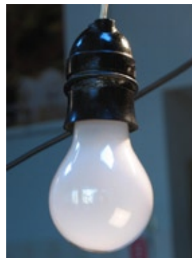
Fig.1. Spaarlamp in armatuur 24W, opgebouwd uit 3 units.
